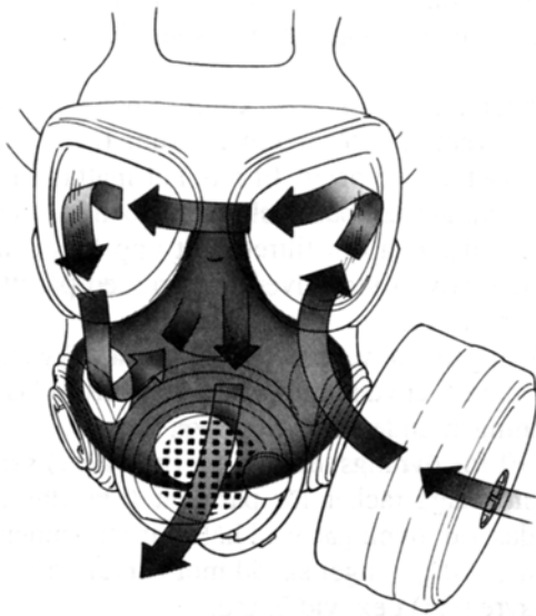
Bild 2. Luftens väg genom skyddsmasken
